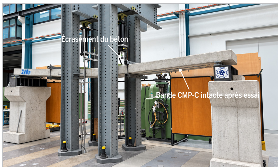
Essai de flexion sur dalle BA avec CMP-C, éprouvette après essai
