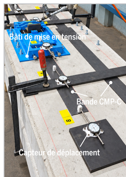
Maquette de mise en oeuvre
