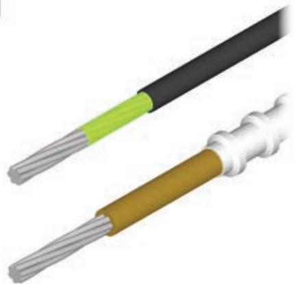
Mono-toron graissé avec gaine PEHD et toron simple avec conduit injecté au coulis de ciment.
